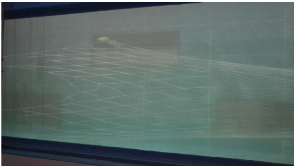
Рисунок 3 – Испытания модели трала 3,3/12м в гидроканале ОАО "Фишеринг Сервис"
