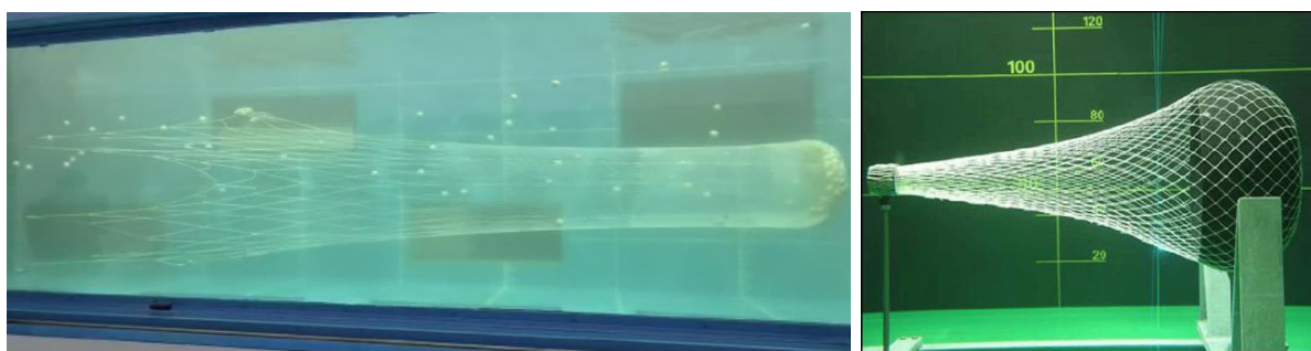
Рисунок 1 – Физические модели тралового мешка с имитацией улова
